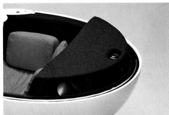
↑ 背もたれ側の背面に配置したサブウーファーユニットは160mm口径を左右両サイドに配置。サブウーファーはパッシブ型のため別途アンプが必要となる
